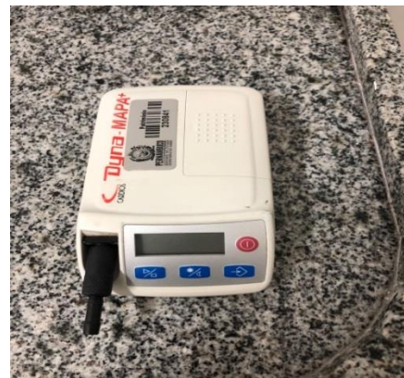
Imagem real do conector (peça preta) e equipamento (Gravador Dyna-Mapa+).
